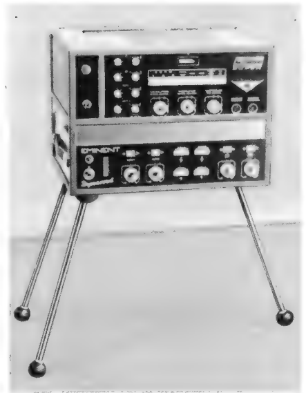
Moderne Musikeranlage von Dynacord. 45-W-Verstärker mit dem Hallgerät Echocord kombiniert
